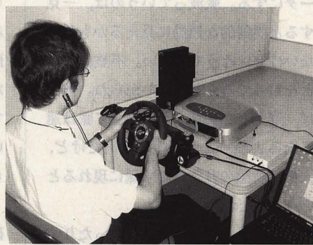
図9●耳たぶで測定する様子 ドライビング・シミュレータで試したところ、運転による緊張が測定できた。
